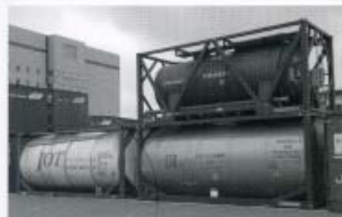
液体の貨物を輸送するISO規格の20フィート・ タンクコンテナ(2008年撮影) 撮影協力:JR貨物
